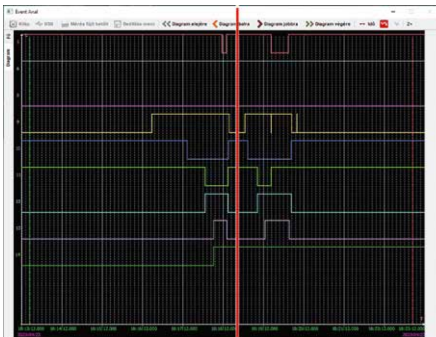
Eseményregiszter logfájl alapján: a vörös vonaltól balra lévő ábrarészleten egy üzemszerű működés, a jobbra lévő ábrarészleten jelzövisszaesést okozó működés látható
