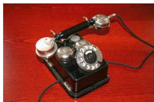
8. ábra: Standard CB24 fémházas távbeszélő-készülék
