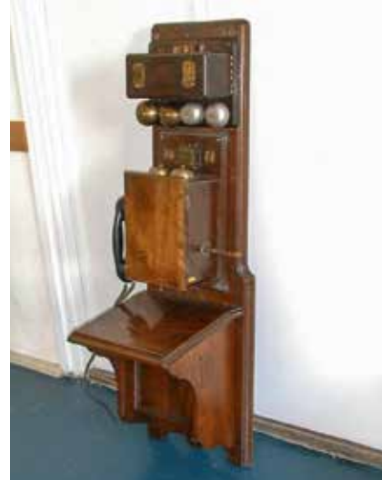
7. ábra: Fali faházás állomási és állomásközi kétirányú LB telefon
