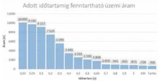
4. ábra: AZ MSZ EN 50122-1:2011 alapján legnagyobb engedélyezhető vontatási áram Gödöllő állomáson mért sínpotenciál-értékek alapján
